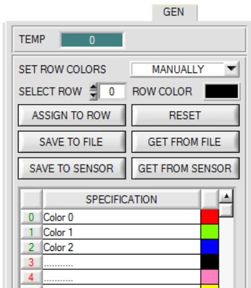
Über **SAVE TO SENSOR** und **GET FROM SENSOR** kann man jetzt die **TABLE ATTRIBUTES** im Sensor hinterlegen bzw. von dort holen.
