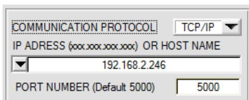
Die **PORT NUMBER** für eine TCP/IP Verbindung wurde Standardmäßig auf **5000** vorinitialisiert.
